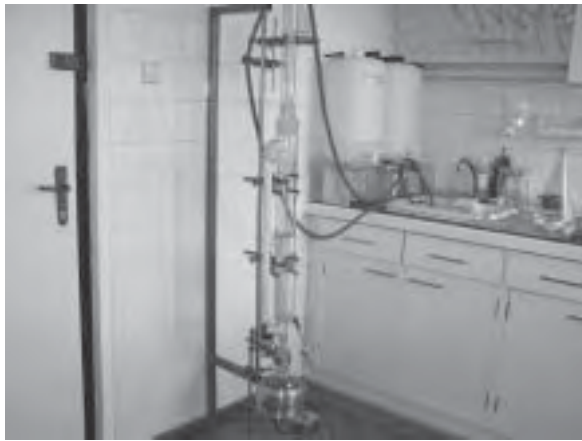
Perforatorski uređaj za ispitivanje slobodnog formaldehida prema HRN EN 120
