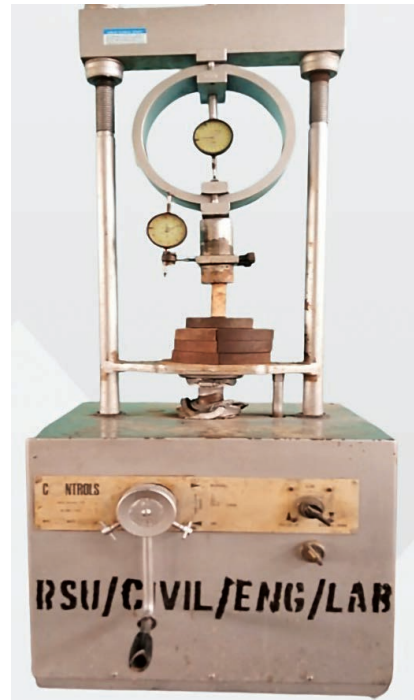
Figure 6 Compression stress parallel to grain test setup Slika 6. Oprema za ispitivanje čvrstoće na tlak paralelno s vlakancima
