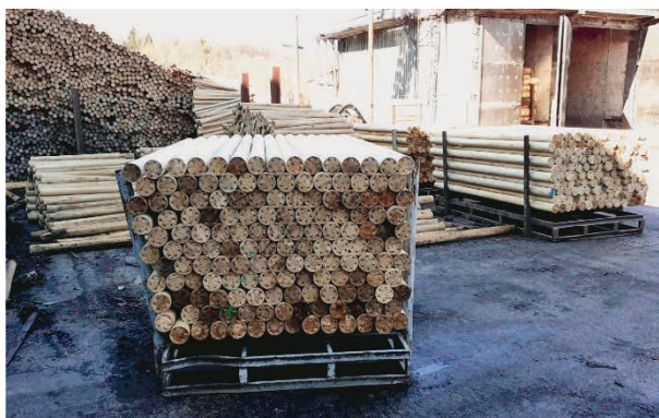
Figure 3 Peeler cores from poplar wood Slika 3. Središnji valjci preostali nakon ljuštenja drva topole
