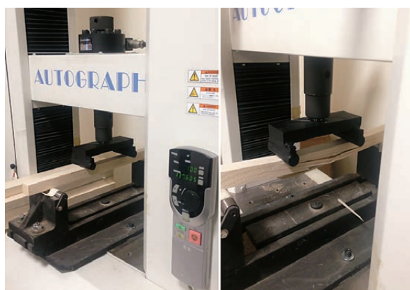
Figure 2 Four-point bending test setup Slika 2. Postavljanje ispitivanja savijanja u četiri točke
